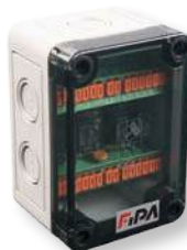
Sensor-Relais-Schaltbox zur Bündelung und Logik-Verknüpfung (UND) der Sensorsignale, da Signaleingänge an der Robotersteuerung meist begrenzt sind
